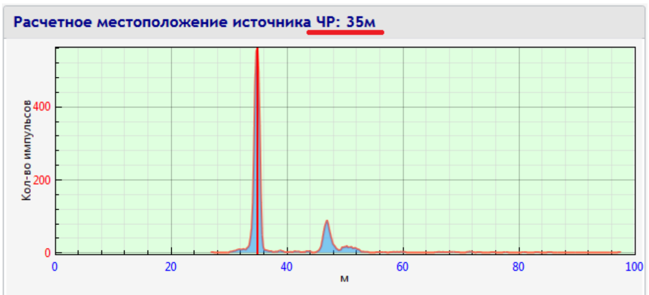
Рис. 49. График количества импульсов по длине кабеля с указанием положения источника ЧР
