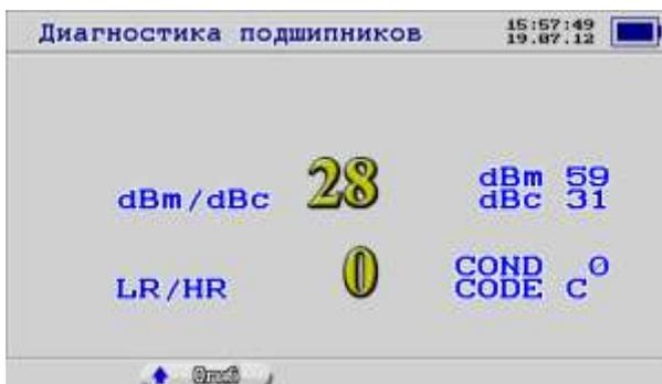
2. Огибающая ударного сигнала. Показывает повторяющиеся удары в подшипнике. Сигнал считывается в течение 1 секунды и выбираются пики ударов в нем.
