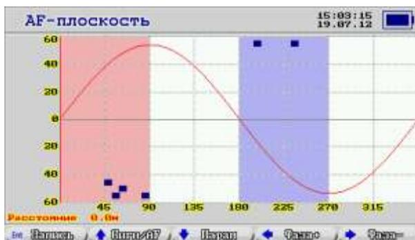
Из сигнала по специальному алгоритму выделяются импульсы и отображаются на плоскости. По вертикали отложена амплитуда в децибелах в логарифмическом масштабе.
