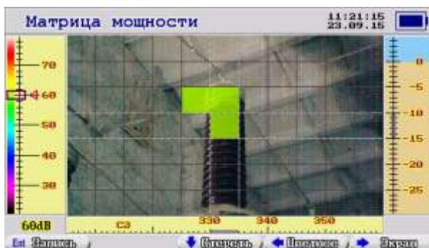
На верхней панели подписан текущий режим работы, дата, время и индикатор заряда аккумуляторов. При сильном разряде его цвет меняется с синего на красный. Это означает, что требуется зарядка аккумулятора или работа от сетевого адаптера. При зарядке аккумулятора на индикаторе «бегают» полоски.
