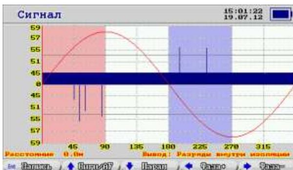
На экране отображается сигнал акустического сигнала, приведенный к синусоиде питающей сети. Внизу – градусы фазы от 0 до 360, слева – децибелы с сеткой в линейном масштабе. Прибор измеряет сигнал длиной 4 периода сети и накладывает эти 4 периода друг на друга.
