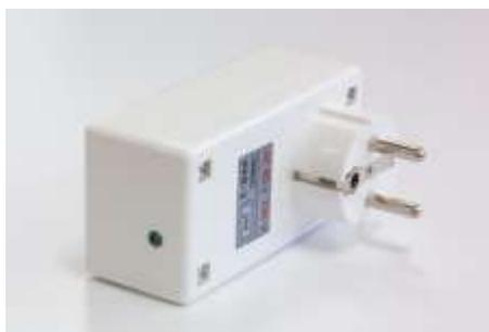
Приемопередатчик синхронизирующих сигналов «PFR-2», показанный на фотографии, предназначен для передачи по радиоканалу синхронизирующих сигналов. В качестве источника синхросигналов используется питающая сеть 220 В.
