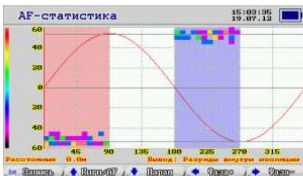
Из AF-плоскости берутся выделенные импульсы и суммируются на плоскости. Цветом отображается количество импульсов с данной фазой и амплитудой. По вертикали отложена амплитуда в децибелах в логарифмическом масштабе.
