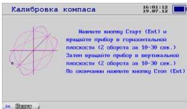
Инструкция по калибровке выводится на экране:
