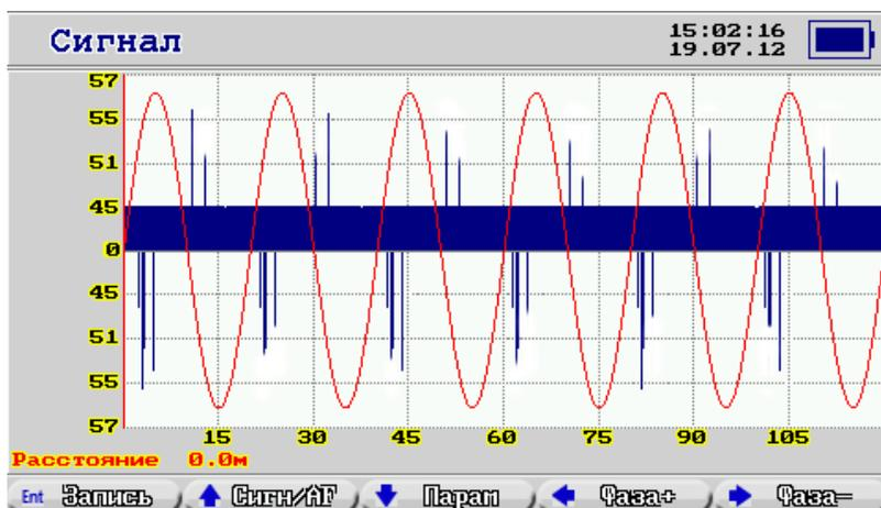
Кнопкой **Ent** можно сохранить сигнал в память для последующего просмотра и передачи его на компьютер.
