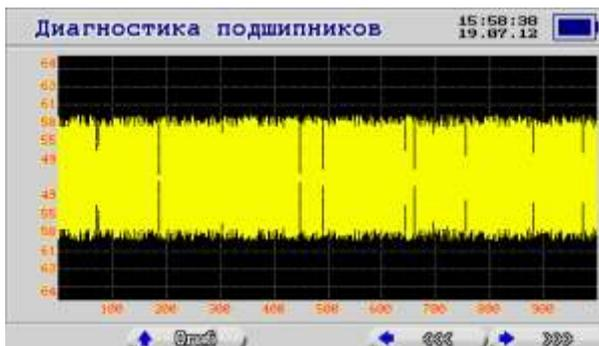
3. Спектр Огибающей ударного сигнала. На спектре хорошо видны гармоники с частотами, отвечающими за элементы подшипника: внешняя и внутренняя обойма, сепаратор, тела качения.
