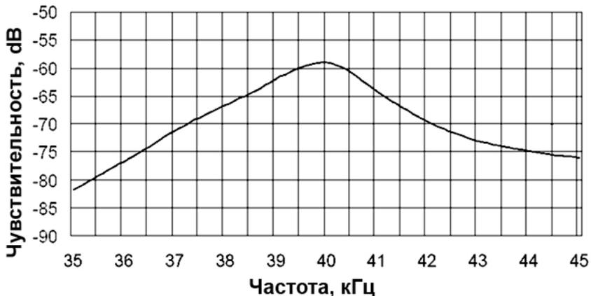
Диаграмма направленности приемного раструба со встроенным датчиком, снятая экспериментально с помощью ультразвукового излучателя «UST», в режиме малой мощности на расстоянии 3 метра.
