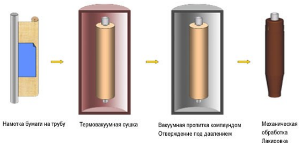
Рис.1 RIP-изоляция высоковольтного ввода
