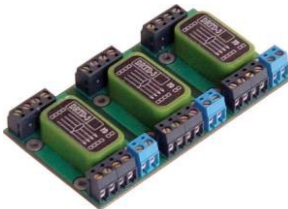
Рисунок 5 Устройство контроля DRTD-3
