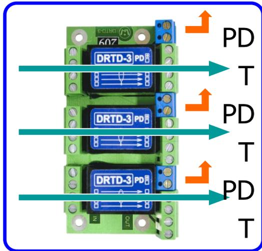
Подключение прибора системы мониторинга для измерения частичных разрядов к датчикам температуры должно происходить так, чтобы не нарушить работу системы температурного контроля обмоток и магнитопровода статора. Для этого в разрыв цепи измерения температуры включаются специализированные датчики марки «DRTD-3», являющиеся высокочастотными трансформаторами тока.
