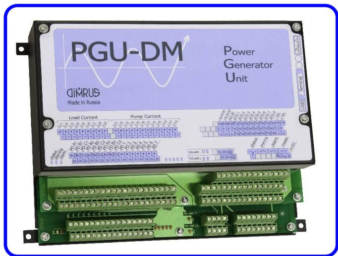
Система мониторинга состояния изоляции энергоблока «PGU-DM» технически реализована в виде единого электронного прибора, монтируемого в защитном шкафу.
