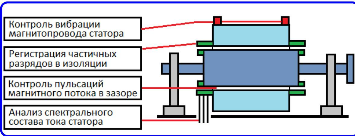
Для оперативного технического мониторинга крупного электрического оборудования все чаще используются современные методы мониторинга и диагностики, основанные на использовании различного микропроцессорного оборудования.
