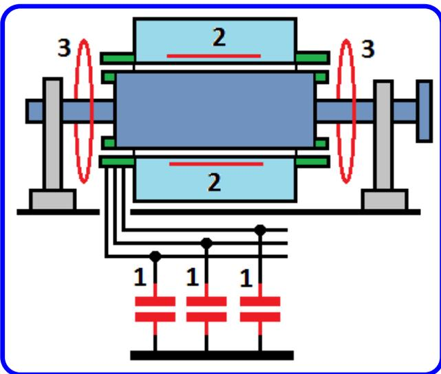
Эффективность работы систем мониторинга состояния изоляции высоковольтных моторов и генераторов по частичным разрядам во многом зависит от типов используемых первичных датчиков и мест их установки.
