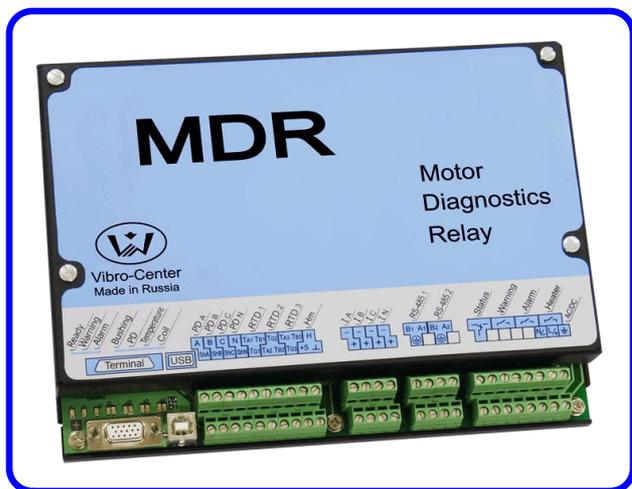
Полная версия прибора «MDR», предназначенная для комплексного мониторинга состояния изоляции обмотки статора выполнена в виде законченного модуля размером 250 \* 200 \* 45 мм. Подключение всех первичных датчиков и линий связи производится при помощи стандартных винтовых клемм.
