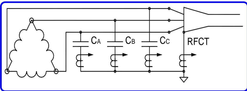
Высоковольтные конденсаторы связи с эпоксидно – слюдяной изоляцией являются наиболее часто используемым типом датчика для регистрации частичных разрядов в электрических машинах. При помощи таких датчиков обычно регистрируют импульсы в диапазоне 1 – 80 МГц.
