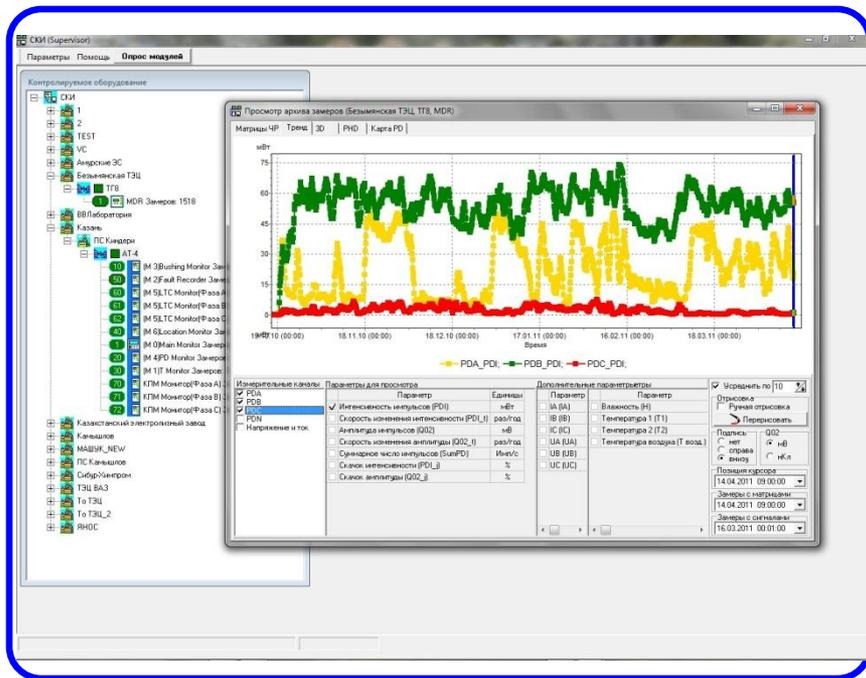
В состав поставки системы MDR входит специализированное программное обеспечение SKI для реализации мониторинга технического состояния электрической машины по контролируемым параметрам на персональном компьютере.
