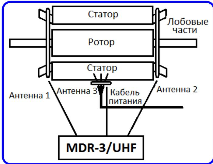
Для комплексного контроля разрядных процессов в статоре и роторе электрической машины удобно использовать электромагнитные антенны, монтируемые в зоне лобовых частей обмотки статора. Кольцевые антенны работают в СВЧ диапазоне, дешевле и эффективнее, чем конденсаторы связи.
