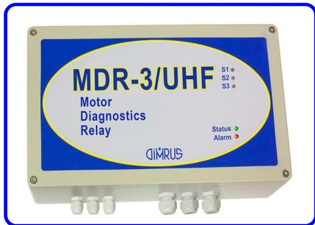
Эта система является последней разработкой фирмы «DIMRUS» для мониторинга технического состояния электрических машин. Она предназначена для использования с СВЧ электромагнитными антеннами, монтируемыми в зоне лобовых частей обмотки статора, и в зоне подключения питающего кабеля.
