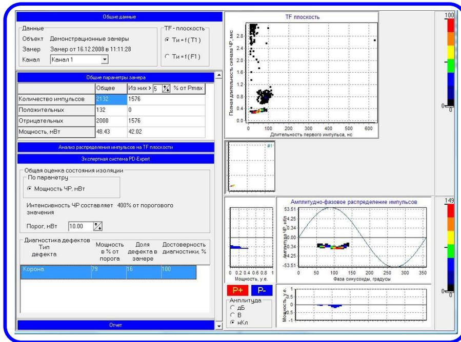
Уникальная возможность системы мониторинга производства фирмы «DIMRUS» – возможность проведения оперативной экспертной диагностики типов выявленных дефектов в изоляции обмотки статора контролируемого генератора (электродвигателя).
