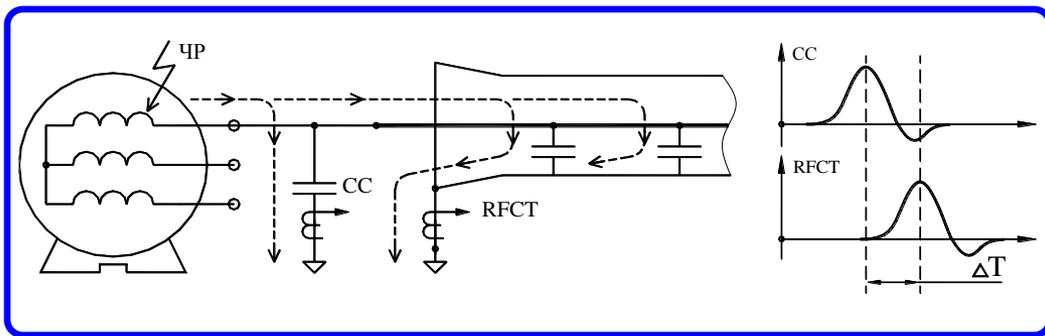
Наибольшей проблемой при использовании для регистрации частичных разрядов конденсаторов связи является отстройка от помех, поступающих по питающему кабелю из внешней сети.
