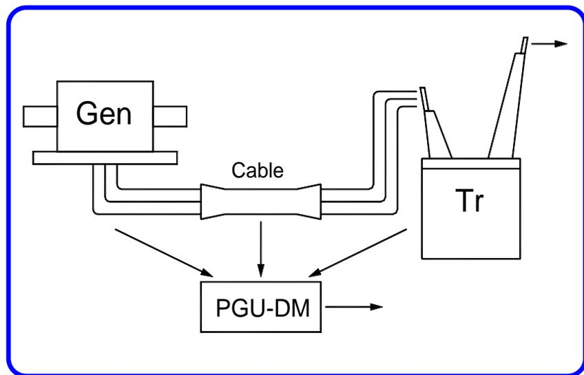
В состав энергоблока станции всегда входит стандартный комплект высоковольтного оборудования – генератор, трансформатор, и кабель, или токопровод между ними.
