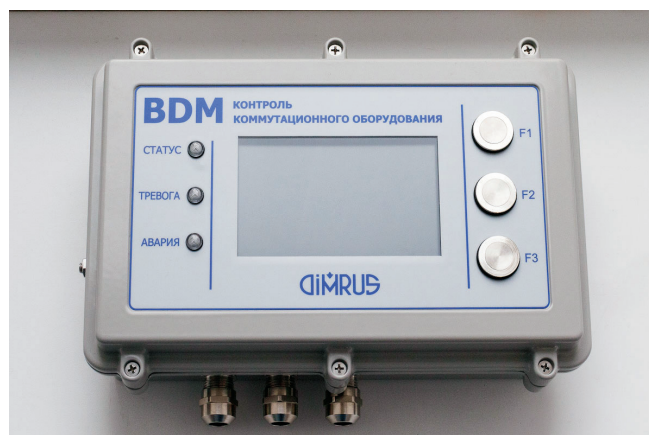
Рис. 3. Центральный прибор BDM системы мониторинга коммутационного оборудования КРУ
