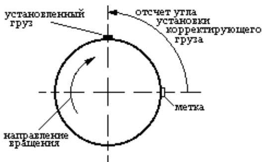
Рисунок 1.4 Схема установки корректирующего груза
