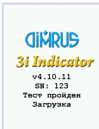
Далее прибор переходит в режим измерения каналов, выбранный при последней работе с прибором.
