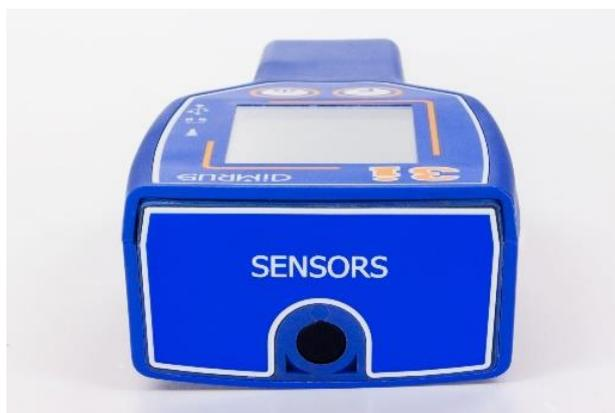
Возможно подключение дополнительных внешних датчиков – акустического (в том числе с параболической антенной), «TSM» и «RFCT». Совместное использование встроенного и внешнего датчиков позволяет проводить дифференциальные измерения в разных точках оборудования, более точно локализовать дефектные места. Использование внешних датчиков также эффективно при проведении измерений в труднодоступных местах, куда установить сам прибор технически невозможно.
