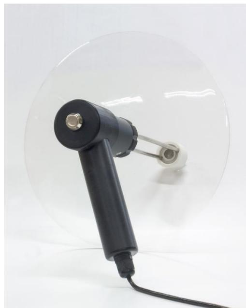
Внешний направленный микрофон с параболической антенной позволяет эффективно проводить анализ разрядной активности удаленно на расстоянии до 100м с точностью до 1м. Прибавка чувствительности составляет 20дБ. Для удобства локации направленный микрофон имеет яркий лазерный указатель. Для включения указателя служит кнопка с торца прибора:
