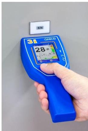
Также, как и в акустическом диапазоне, можно проводить измерения с помощью как встроенного, так и внешнего датчиков TEV. Для подключения датчика к прибору используется кабель с маркировкой «TEV».
