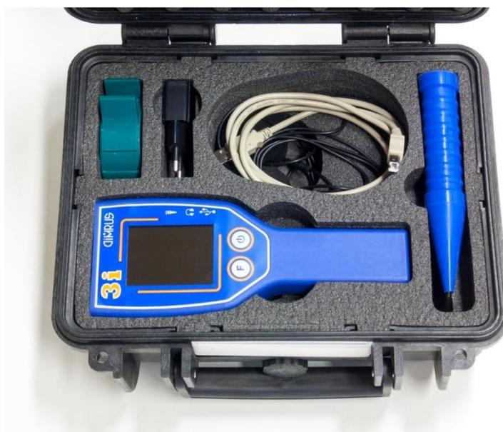
Расширенный комплект датчиков позволяет проводить измерения частичных разрядов с привязкой к фазе с помощью датчика частоты сети «PFR-2». Также содержит дополнительный датчик «TSM», акустический направленный микрофон с параболической антенной и датчик «RFCT».
