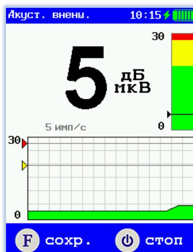
Дополнительно пользователь может оперативно контролировать уровень и интенсивность зарегистрированных частичных разрядов при помощи наушников, входящих в комплект прибора. Сигнала с акустического датчика аппаратно сдвигается в слышимый диапазон и подается на наушники, позволяя на слух оценивать разрядную обстановку.
