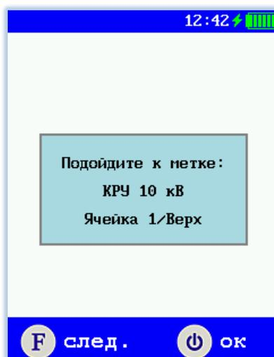
Когда метка выбрана, необходимо нажать на кнопку «ОК», прибор перейдет в режим поиска и программирования метки. В случае успешной выгрузки данных на метку будет выведено сообщение об успешном обновлении метки и будет предложено выбрать следующую метку маршрута. Выйти из режима программирования меток можно по клавише «F».
